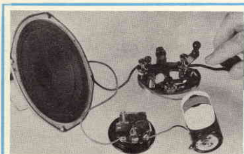
Collegando un altoparlante in serie con un tasto telegrafico, una batteria ed un cicalino, si potrà udire un suono abbastanza chiaro e forte.
